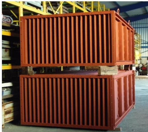
В качестве поверхности теплопередачи используются прессованные пластины, уложенные в пучки. Пластины имеют зазоры между ними, которые создают пространство для воздушного потока. Дымовой газ протекает через полости в пластинах. Вся сборка обшита стальным корпусом.
