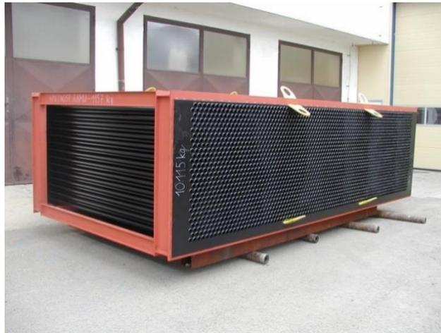
Основным элементом трубчатых нагревателей являются трубки. Параллельные трубки соединены так называемыми трубными листами, которые представляют собой стальные листы с отверстиями для удлинения труб. Трубки приварены к трубным пластинам и вместе они образуют пучок. Вся сборка обшита стальным корпусом. Воздуходувки можно использовать для очистки.
